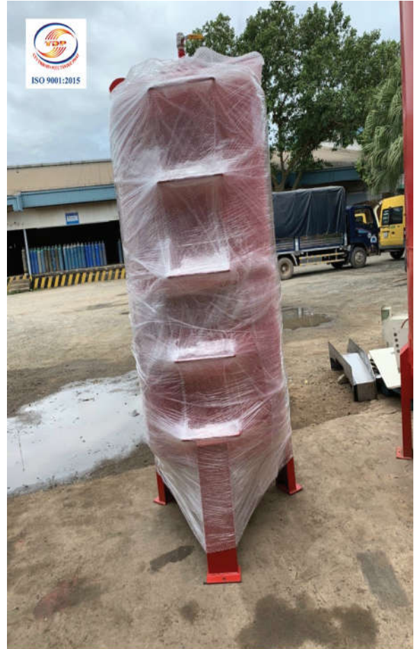
Bồn Foam hoàn thiện được quấn lớp PE
